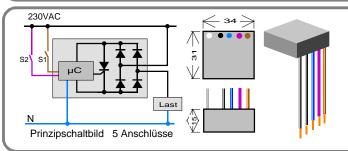
5-Leiter Bauteile nennen wir nicht mehr "Schaltverzögerer" sondern "Steuermodule". Diese verfügen über zwei Steuereingänge. Über diese können auch komplexe Schaltabläufe gesteuert oder beeinflusst werden. Bitte fragen Sie an.
