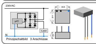
3-Leiter Schaltverzögerer erhalten ihre Betriebsspannung über den Anschluß N. Diese Module werden mit den Funktionen
